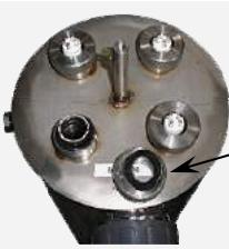
Отвернуть гайку из нержавеющей стали
