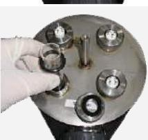
Удерживайте кварцевую трубку и извлеките ее полностью, следя за тем, чтобы она правильно входила вдоль оси..
