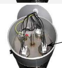
Соединить вновь каждый разъем лампы.. (Не применяйте больших усилий к разъему на его месте : Существует особое направление соединения) и зажмите разъем нержавеющими гайками.
