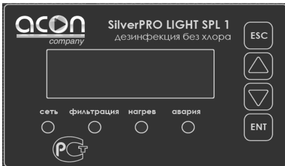
Двухстрочный жидкокристаллический дисплей для настройки и отображения рабочих и установочных параметров.
